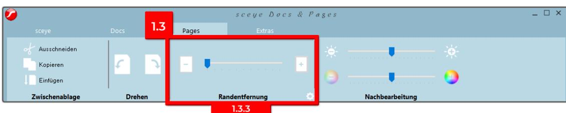
Mit dieser Funktion wird der womöglich unsaubere Rand eines Scans (teils kann die Scanunterlage zu erkennen sein) automatisch entfernt. Wählen Sie die Seite aus, die Sie nachbearbeiten möchten. Je weiter Sie den Regler nach rechts schieben, desto mehr Rand wird entfernt. Sofern wichtige Informationen sehr nach am Rand erhalten bleiben, müssen sollten Sie den Regler ganz links belassen.
